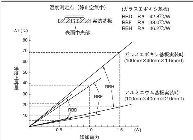
70°Cにおいて定格電力にて連続使用される場合は、金属系の基板をご使用下さい。またガラスエポキシ基板に実装の際は、基板温度が90°Cを超えないような条件でご使用願います。
